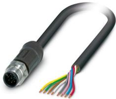
Sensor-/Aktor-Kabel, 8-polig, PE-X halogenfrei, schwarzgrau RAL 7021, Stecker gerade M12, Kodierung: A, auf freies Leitungsende, Kabellänge: 10 m, für Außenanwendungen, mit Edelstahlrändel
