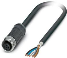
Sensor-/Aktor-Kabel, 5-polig, PE-X/PE-X halogenfrei, schwarzgrau RAL 7021, geschirmt, freies Leitungsende, auf Buchse gerade M12, Kodierung: A, Kabellänge: 5 m, für Außenanwendungen, mit Edelstahlrändel
