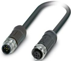
Sensor-/Aktor-Kabel, 5-polig, PE-X halogenfrei, schwarzgrau RAL 7021, Stecker gerade M12, Kodierung: A, auf Buchse gerade M12, Kodierung: A, Kabellänge: 5 m, für Außenanwendungen, mit Edelstahlrändel
