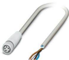
Sensor-/Aktor-Kabel, 4-polig, PP-EPDM halogenfrei, grau RAL 7035, freies Leitungsende, auf Buchse gerade M8, Kodierung: A, Kabellänge: 3 m, Hygienic Design, mit Kunststoffrändel
