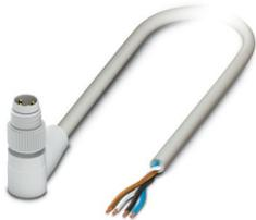
Sensor-/Aktor-Kabel, 4-polig, PP-EPDM halogenfrei, grau RAL 7035, Stecker gewinkelt M8, Kodierung: A, auf freies Leitungsende, Kabellänge: 10 m, Hygienic Design, mit Kunststoffrändel
