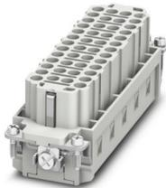
Kontakteinsatz, Polzahl: 46+PE, Baugröße: B24, Buchse, Crimpanschluss, 500 V, 16 A, 0,5 mm<sup>2</sup> ... 4 mm<sup>2</sup>, Anwendung: Leistung
