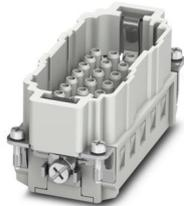
Kontakteinsatz, Polzahl: 32+PE, Baugröße: B16, Stift, Crimpanschluss, 500 V, 16 A, 0,5 mm<sup>2</sup> ...
