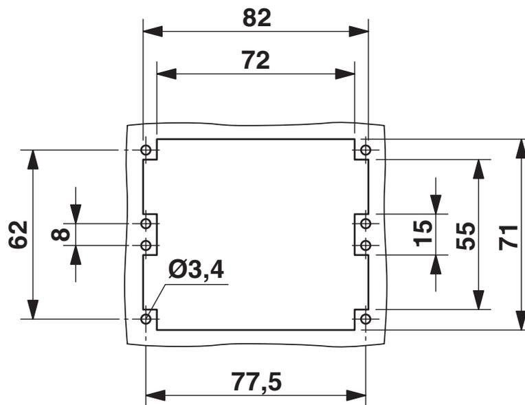
Montageausschnitt bei Verwendung ohne Gehäuse
