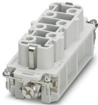
Kontakteinsatz, Polzahl: 6+PE, Baugröße: B16, Anzahl der Anschlüsse je Pol: 1, Buchse, Schraubanschluss, 400 V/690 V, 41 A, 0,5 mm<sup>2</sup> ... 6 mm<sup>2</sup>, Anwendung: Leistung
