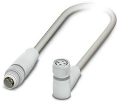
Sensor-/Aktor-Kabel, 3-polig, PP-EPDM halogenfrei, grau RAL 7035, Stecker gerade M8, Kodierung: A, auf Buchse gewinkelt M8, Kodierung: A, Kabellänge: 0,3 m, Hygienic Design, mit Kunststoffrändel
