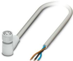
Sensor-/Aktor-Kabel, 3-polig, PP-EPDM halogenfrei, grau RAL 7035, freies Leitungsende, auf Buchse gewinkelt M8, Kodierung: A, Kabellänge: 1,5 m, Hygienic Design, mit Kunststofffrüdel
