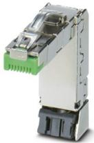
RJ45-Steckverbinder, Bauform: RJ45, Schutzart: IP20, Polzahl: 6, 100 MBit/s, CAT5 (IEC 11801:2002), Material: Metall, Anschlussart: Schneidklemmanschluss, Anschlussquerschnitt: AWG 26- 24, Kabelabgang: gewinkelt, Hohe Vibrationsfestigkeit; 360°-Schirmung; One-Piece Design; spezialwerkzeuglose Konfektion, VARAN
