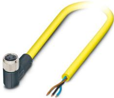
Sensor-/Aktor-Kabel, 3-polig, PVC, gelb, freies Leitungsende, auf Buchse gewinkelt M8, Kodierung: A, Kabellänge: 2 m
