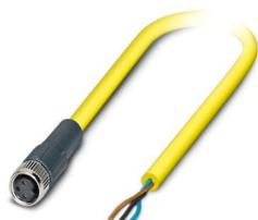
Sensor-/Aktor-Kabel, 3-polig, PVC, gelb, freies Leitungsende, auf Buchse gerade M8, Kodierung: A, Kabellänge: 2 m
