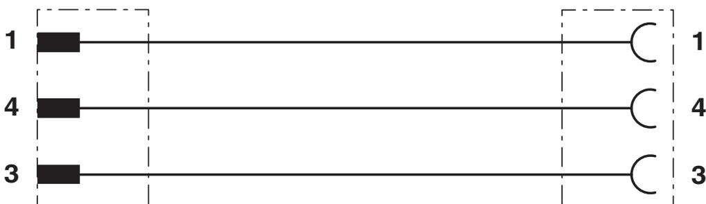
Kontaktbelegung der M8-Stecker / M12-Buchse
