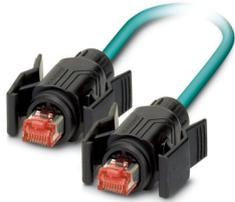
Konfektioniertes Ethernet-Kabel, CAT5e, geschirmt, 2-paarig, AWG 26 flexibel (7-drähtig), RAL 5021 (wasserblau), RJ45-Stecker/IP67, schwarz auf RJ45-Stecker/IP67, schwarz, Line, Länge 5 m
