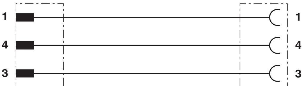
Kontaktbelegung der M8-Stecker / M12-Buchse
