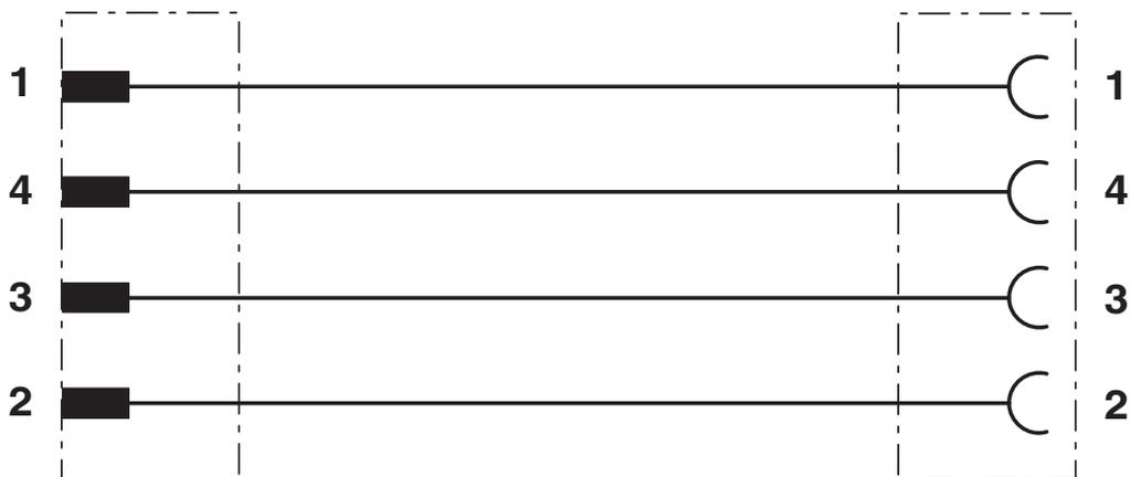
Kontaktbelegung der M12-Stecker / M8-Buchse
