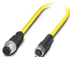
Sensor-/Aktor-Kabel, 4-polig, PVC, gelb, Stecker gerade M12, Kodierung: A, auf Buchse gerade M8, Kodierung: A, Kabellänge: 1,5 m
