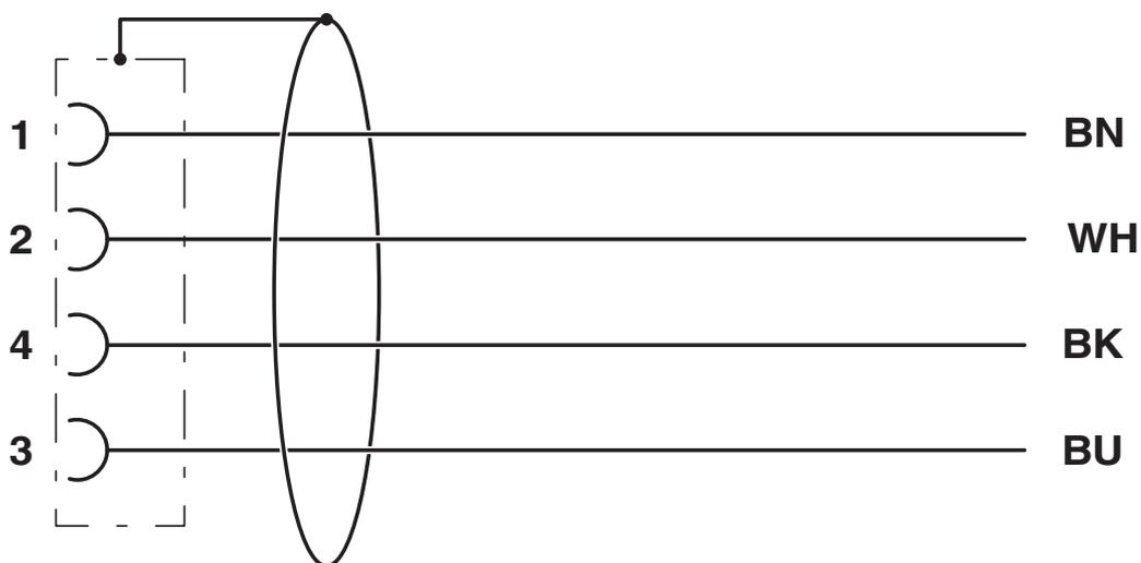
Kontaktbelegung des M12-Stecker und der M12-Buchse
