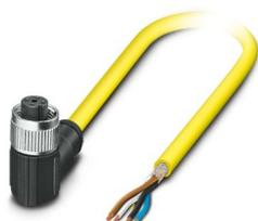
Sensor-/Aktor-Kabel, 4-polig, PVC, gelb, geschirmt, freies Leitungsende, auf Buchse gewinkelt M12, Kodierung: A, Kabellänge: 10 m
