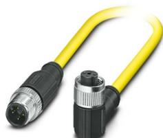
Sensor-/Aktor-Kabel, 4-polig, PVC, gelb, geschirmt, Stecker gerade M12, Kodierung: A, auf Buchse gewinkelt M12, Kodierung: A, Kabellänge: 0,5 m
