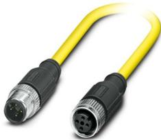
Sensor-/Aktor-Kabel, 4-polig, PVC, gelb, geschirmt, Stecker gerade M12, Kodierung: A, auf Buchse gerade M12, Kodierung: A, Kabellänge: 1,5 m
