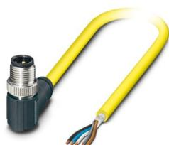
Sensor-/Aktor-Kabel, 5-polig, PVC, gelb, geschirmt, Stecker gewinkelt M12, Kodierung: A, auf freies Leitungsende, Kabellänge: 5 m
