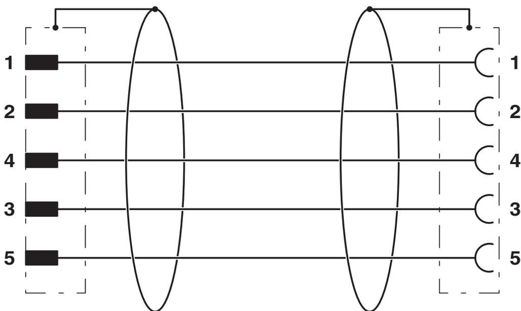
Kontaktbelegung des M12-Stecker und der M12-Buchse
