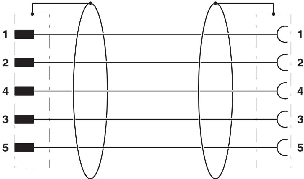
Kontaktbelegung des M12-Stecker und der M12-Buchse
