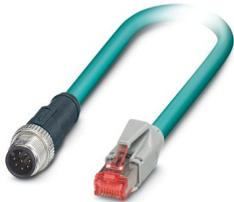
Netzwirkkabel, Ethernet CAT5 (1 GBit/s), 8-polig, PUR halogenfrei, wasserblau RAL 5021, geschirmt, Stecker gerade M12, Kodierung: A / IP67, auf Stecker gerade RJ45 / IP20, Kabellänge: 2 m
