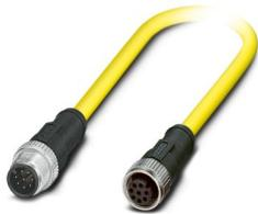
Sensor-/Aktor-Kabel, 8-polig, PVC, gelb, Stecker gerade M12, Kodierung: A, auf Buchse gerade M12, Kodierung: A, Kabellänge: 1,5 m
