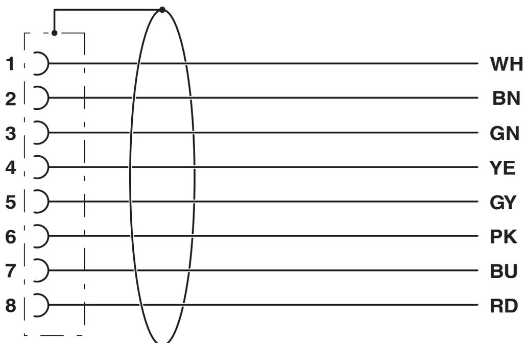
Kontaktbelegung der M12-Buchse
