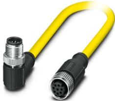
Sensor-/Aktor-Kabel, 8-polig, PVC, gelb, geschirmt, Stecker gewinkelt M12, Kodierung: A, auf Buchse gerade M12, Kodierung: A, Kabellänge: 1,5 m
