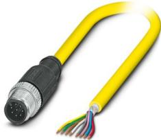
Sensor-/Aktor-Kabel, 8-polig, PVC, gelb, geschirmt, Stecker gerade M12, Kodierung: A, auf freies Leitungsende, Kabellänge: 2 m
