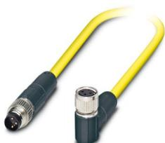
Sensor-/Aktor-Kabel, 3-polig, PVC, gelb, geschirmt, Stecker gerade M8, auf Buchse gewinkelt M8, Kabellänge: 1,5 m
