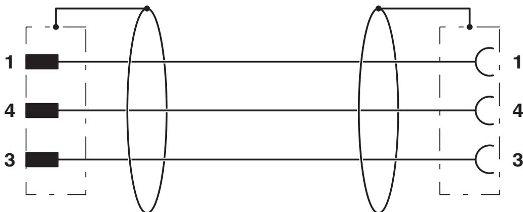
Kontaktbelegung der M8-Stecker/Buchse
