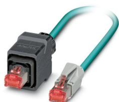
Konfektioniertes Ethernet-Kabel, CAT5e, geschirmt, 2-paarig, AWG 26 flexibel (7-drähtig), RAL 5021 (wasserblau), RJ45-Stecker/IP67 Push-Pull Kunststoffgehäuse auf RJ45-Stecker/IP20, Line, Länge 5 m
