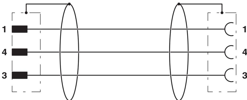
Kontaktbelegung der M12-Stecker / M8-Buchse
