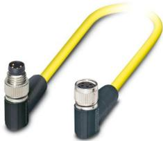
Sensor-/Aktor-Kabel, 4-polig, PVC, gelb, geschirmt, Stecker gewinkelt M8, auf Buchse gewinkelt M8, Kabellänge: 0,5 m
