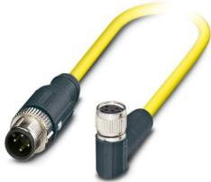
Sensor-/Aktor-Kabel, 4-polig, PVC, gelb, geschirmt, Stecker gerade M12, Kodierung: A, auf Buchse gewinkelt M8, Kabellänge: 0,5 m
