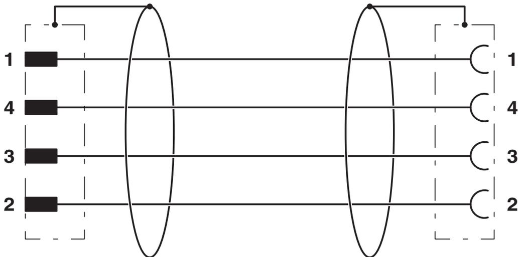
Kontaktbelegung der M12-Stecker / M8-Buchse
