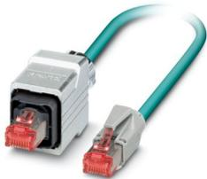
Konfektioniertes Ethernet-Kabel, CAT5e, geschirmt, 2-paarig, AWG 26 flexibel (7-drähtig), RAL 5021 (wasserblau), RJ45-Stecker/IP67 Push-Pull Metallgehäuse auf RJ45-Stecker/IP20, Line, Länge 5 m
