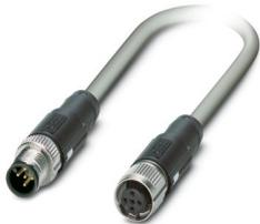
Bussystem-Kabel, CANopen®, DeviceNet™, 5-polig, PVC, grau, geschirmt, Stecker gerade M12, Kodierung: A, auf Buchse gerade M12, Kodierung: A, Kabellänge: 0,5 m, Steckverbinder ungeschirmt
