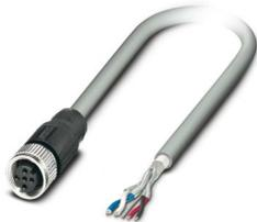
Bussystem-Kabel, CANopen®, DeviceNet™, 5-polig, PVC, grau, geschirmt, freies Leitungsende, auf Buchse gerade M12, Kodierung: A, Kabellänge: 5 m, Steckverbinder ungeschirmt
