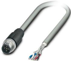
Bussystem-Kabel, CANopen®, DeviceNet™, 5-polig, PVC, grau, geschirmt, Stecker gerade M12, Kodierung: A, auf freies Leitungsende, Kabellänge: 5 m, Steckverbinder ungeschirmt
