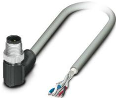
Bussystem-Kabel, CANopen®, DeviceNet™, 5-polig, PVC, grau, geschirmt, Stecker gewinkelt M12, Kodierung: A, auf freies Leitungsende, Kabellänge: 2 m, Steckverbinder ungeschirmt
