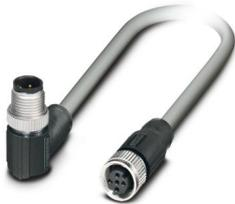
Bussystem-Kabel, CANopen®, DeviceNet™, 5-polig, PVC, grau, geschirmt, Stecker gewinkelt M12, Kodierung: A, auf Buchse gerade M12, Kodierung: A, Kabellänge: 0,5 m, Steckverbinder ungeschirmt
