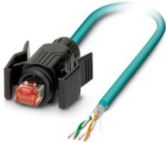
Konfektioniertes Ethernet-Kabel, CAT5e, geschirmt, 2-paarig, AWG 26 flexibel (7-drähtig), RAL 5021 (wasserblau), RJ45-Stecker/IP67, schwarz auf freies Leitungsende, Line, Länge 5 m
