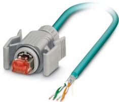
Konfektioniertes Ethernet-Kabel, CAT5e, geschirmt, 2-paarig, AWG 26 flexibel (7-drähtig), RAL 5021 (wasserblau), RJ45-Stecker/IP67, grau auf freies Leitungsende, Line, Länge 2 m
