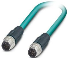
Konfektioniertes Ethernet-Kabel, geschirmt, 4-paarig, AWG 26 flexibel (7-drähtig), RAL 5021 (wasserblau), M12-Stecker auf M12-Stecker, Line, Länge 5 m
