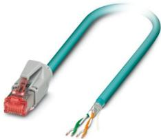
Konfektioniertes Ethernet-Kabel, CAT5e, geschirmt, 2-paarig, AWG 26 flexibel (7-drähtig), RAL 5021 (wasserblau), RJ45-Stecker/IP20 auf freies Leitungsende, Line, Länge 1 m
