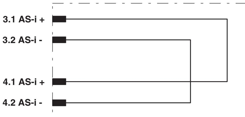
Kontaktbelegung des AS-Interface Verteilers
