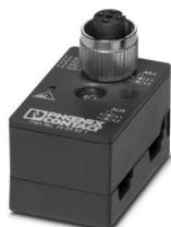
AS-Interface Verteiler in hoher Schutzart, für einen Abzweig von zwei Flachleitungen auf eine gerade, A-kodierte, 4-polige M12 Buchse
