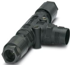
QUICKON T-Verteiler, schwarz, 4+PE-polig, 1,0 mm<sup>2</sup> ... 2,5 mm<sup>2</sup> / 690 V / 20 A, für Kabeldurchmesser 6 mm ... 11 mm, mit zwei QUICKON-Muttern
