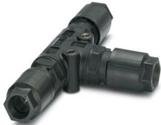
T-Verteiler, Anschlussart: IDC-Anschluss, Polzahl: 4+PE, 1 mm<sup>2</sup> ... 2,5 mm<sup>2</sup>, 690 V, 20 A, PA, schwarz, mit drei QUICKON-Muttern, Kodierung: Kodierprofil, Leitungsaußendurchmesser: 6 mm ... 11 mm
