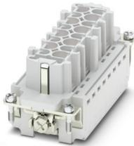
Kontakteinsatz, Polzahl: 6+2+PE, Baugröße: B16, Leistungskontakte: 6, Steuerkontakte: 2, Anzahl der Anschlüsse je Pol: 1, Buchse, Crimpanschluss, 690 V, 16 A, 0,5 mm<sup>2</sup> ... 4 mm<sup>2</sup>
