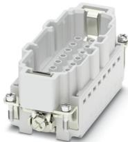
Kontakteinsatz, Polzahl: 6+2+PE, Baugröße: B16, Leistungskontakte: 6, Steuerkontakte: 2, Anzahl der Anschlüsse je Pol: 1, Stift, Crimpanschluss, 690 V, 16 A, 0,5 mm<sup>2</sup> ... 4 mm<sup>2</sup>
