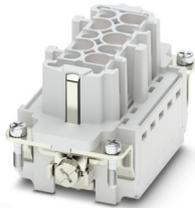
Kontakteinsatz, Polzahl: 3+2+PE, Baugröße: B10, Leistungskontakte: 3, Steuerkontakte: 2, Anzahl der Anschlüsse je Pol: 1, Buchse, Crimpanschluss, 690 V, 16 A, 0,5 mm<sup>2</sup> ... 4 mm<sup>2</sup>
